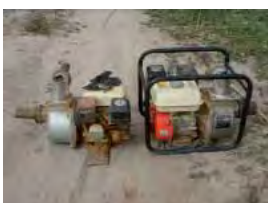
Une motopompe (1) Puissance de 3,5-4,5 CV, diamètre aspiration/refoulement 2" (Capable de pomper 15-20 m3/h)
