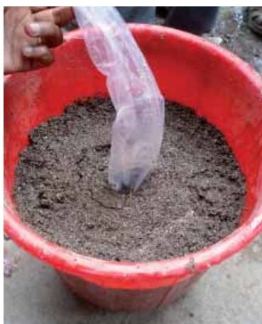
Effondrement du 'trou de forage' (seau)
