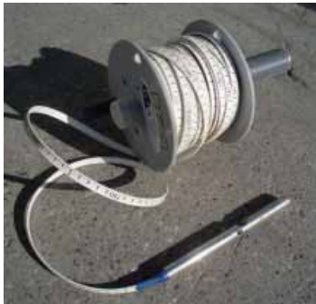
Sonde piézométrique électrique
