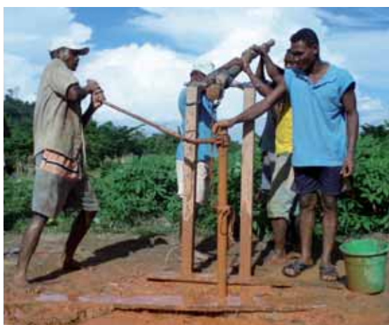
La foreuse rotative à boue en action
